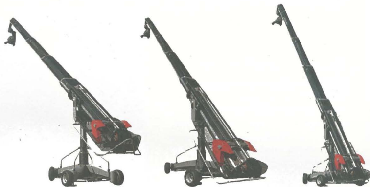
Het tegengewicht van de telescooparm verschuift als de arm uitschuift of onder een andere hoek komt te staan
