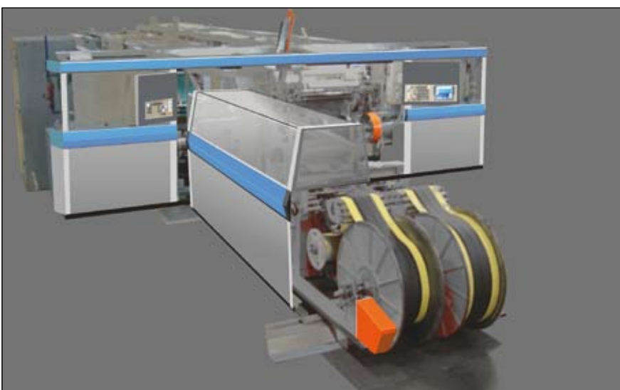
Afbeelding 7. Uniforme afscherming met de afgesproken stijlelementen van een machine (ref. VMI Holland).
